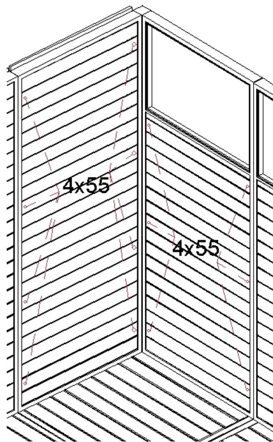
3. Закрепите панели стены шурупами 4x55, более высокие 8 шт. шурупами и более короткие 6 шт. шурупами.
