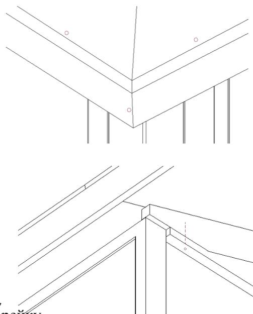
9. Закрепите двумя шурупами 5x90 центральную потолочную рейку.
