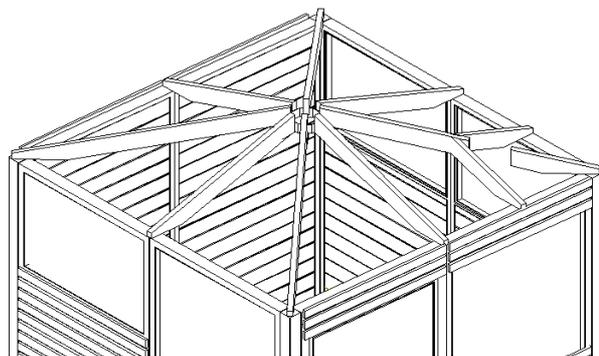
6. Закрепите верхнюю часть стропил двумя винтами 5x35 к центральной опорной детали, нижнюю часть стропил, одним шурупом ом, к верхней поверхности стен.
